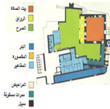
شكل (7): كيفية ربط المسجد بالمناطق الخضراء ليتم تصريف مياه الوضوء إليها [15]
